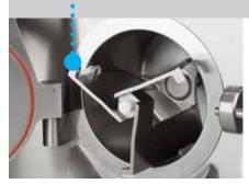
Le volume du cylindre en centimètres cubes est distribué en fonction d'un rapport précis entre le diamètre et la profondeur du cylindre, étudié et testé dans le but d'obtenir une parfaite synthèse entre le rendu frigorifique, la vitesse de congélation et de micro-cristallisation de l'eau et l'optimisation de l'incorporation de l'air.
