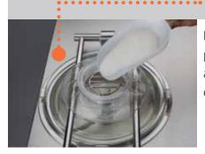
Double système d'ouverture du couvercle servo-assisté par pistons hydrauliques, pour une introduction aisée des ingrédients. Les ingrédients peuvent être ajoutés durant l'exécution de la phase de travail, sans arrêt de la machine, sans enfreindre les normes de sécurité certifiées CE.
