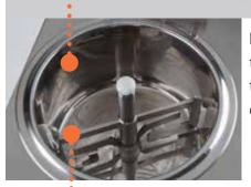
Le rapport entre le diamètre et la profondeur de la cuve crée un "récipient technologique" ayant une base est très large, ce qui permet d'optimiser l'échange thermique sur le fond sans brûler ou endommager le produit se trouvant dans la cuve, même dans le cas de produits délicats ou de quantité minime.
